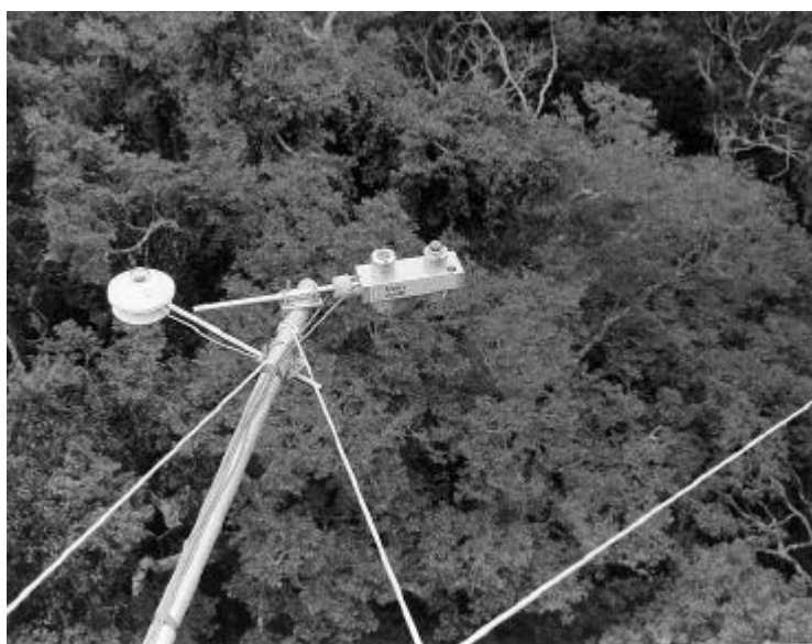
Fig. 1 - Conjunto de sensores de radiação instalados na torre micrometeorológica, apresentando um albedômetro (à esquerda) e um saldo-radiômetro (à direita), da foto.
